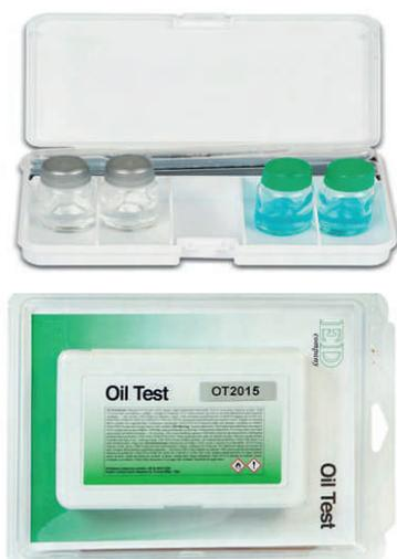
È l'attrezzatura chimica più recente che permette di identificare in pochi secondi il tipo di olio nei sistemi di refrigerazione e condizionamento.
