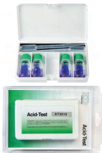
È un prodotto indispensabile per individuare la presenza e la formazione dell'acido all'interno degli impianti di refrigerazione e condizionamento. L'utilizzo di ACID TEST è un passaggio molto importante in una regolare manutenzione preventiva e fornisce un metodo veloce ed accurato per rilevare la presenza di acido nei lubrificanti.
