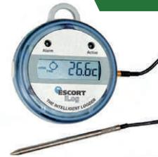
DLPT100 data logger di temperatura a tenuta stagna IP67 a 2 canali con sensore interno e display multifunzione la visualizzazione di :
